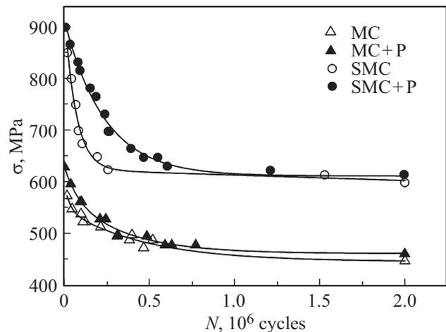
Зависимость напряжения от количества циклов  $N$  до разрушения при усталостных испытаниях сплава ВТ1-0 в МК (МК) и СМК (СМК) состояниях, а также после их обработки высоким гидростатическим давлением (+P).
