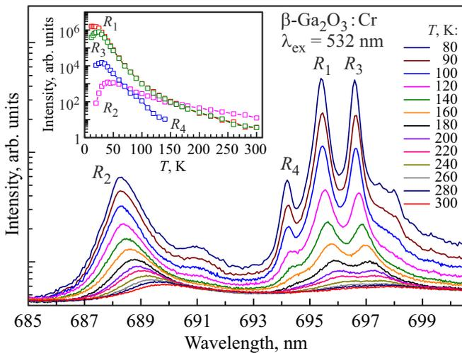
**Рис. 3.** Спектры ФЛ  $\beta\text{-Ga}_2\text{O}_3\text{:Cr}$  в диапазоне температур 80–300 К. Спектры получены от плоскости (100). На вставке показана зависимость интенсивности линий  $R_1$ ,  $R_2$ ,  $R_3$  и  $R_4$  в диапазоне температур 10–300 К. Все данные представлены в полулогарифмическом масштабе.
