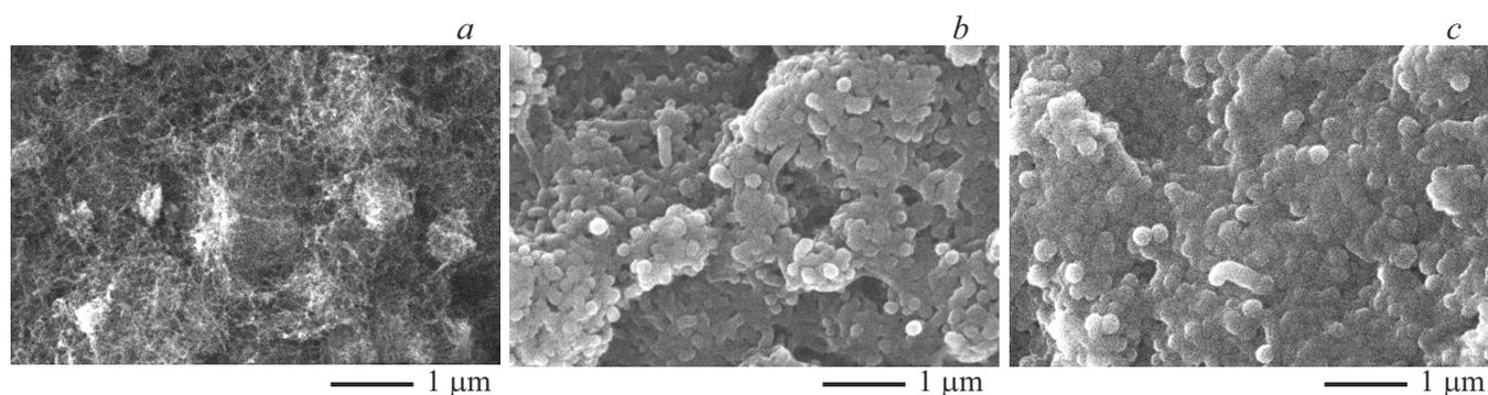
**Рис. 1.** РЭМ-изображения: *a* — поверхности слоя УНТ; *b* — поверхности композита УНТ/TiO<sub>2</sub>; *c* — поверхности композита УНТ/TiO<sub>2</sub> после облучения ионами азота.
