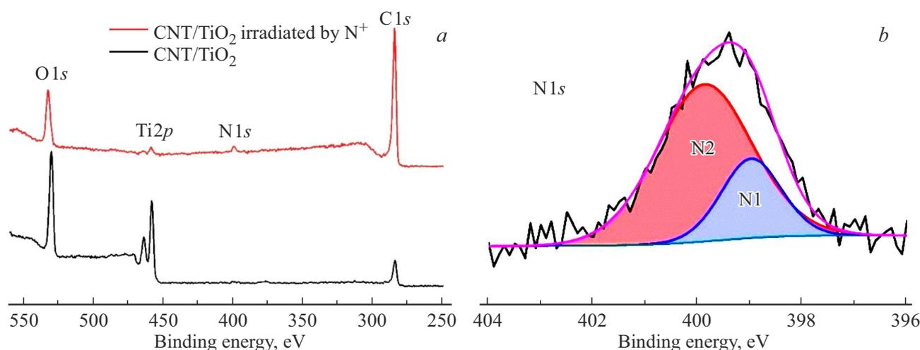
**Рис. 2.** *a* — Обзорные РФЭС-спектры поверхности композита УНТ/TiO<sub>2</sub> до и после облучения ионами азота; *b* — РФЭС-спектр N1s композита УНТ/TiO<sub>2</sub> после облучения ионами азота.
