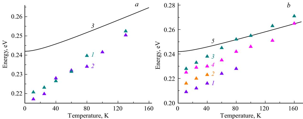
**Рис. 3.** *a* — температурные зависимости энергий пиков ФО нелегированного образца С после отжига для заполнения вакансий (1) и после активационного отжига (2), зависимость  $E_g(T)$  для  $x = 0.30$  (3), *b* — аналогичные зависимости для легированных образцов после роста (А — (1), В — (2)) и после активационного отжига (А — (3), В — (4)), зависимость  $E_g(T)$  для  $x = 0.30$  (5).
