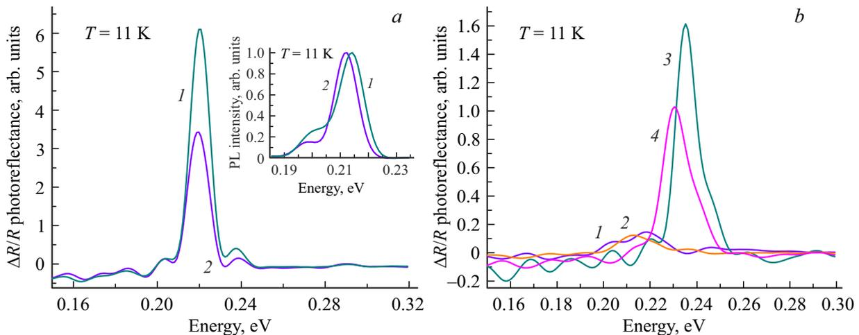
**Рис. 2.** *a* — спектры ФО и ФЛ (на вставке) образца С после отжига для заполнения вакансий (1) и после активационного отжига (2) и *b* — спектры ФО легированных образцов после роста (А — (1), В — (2)) и после активационного отжига (А — (3), В — (4)).
