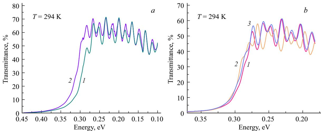
**Рис. 1.** *a* — спектры ОП легированного образца А после роста (1) и после активационного отжига (2) и *b* — нелегированного образца С после роста (1), после отжига для заполнения вакансий (2) и после активационного отжига (3). (Цветной вариант рисунка представлен в электронной версии статьи).
