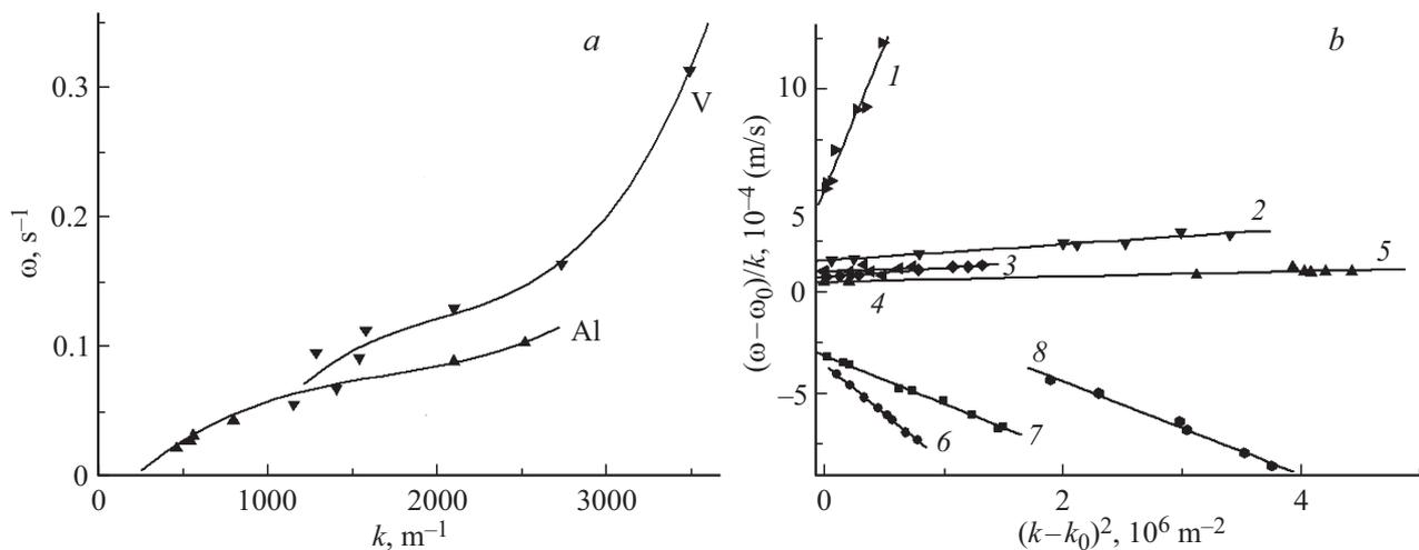
**Рис. 3.** Дисперсия при коллапсе автоволны локализованной пластичности. Исходные данные для V и Al (a). То же в функциональных координатах: 1 — D1, 2 — V, 3 — Ti, 4 — Mg, 5 — Al (крупнозернистый), 6 — Zr, 7 — FeSi, 8 — Al (мелкозернистый) (b).
