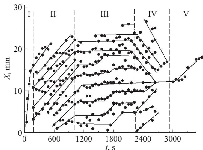
**Рис. 2.**  $X-t$  диаграмма пластической деформации наводороженного поликристаллического сплава Cr–Ni аустенита. Стадии: I — деформация Людерса; II — стадия линейного деформационного упрочнения; III — стадия параболического деформационного упрочнения; IV — стадия предразрушения; V — стадия вязкого разрушения.
