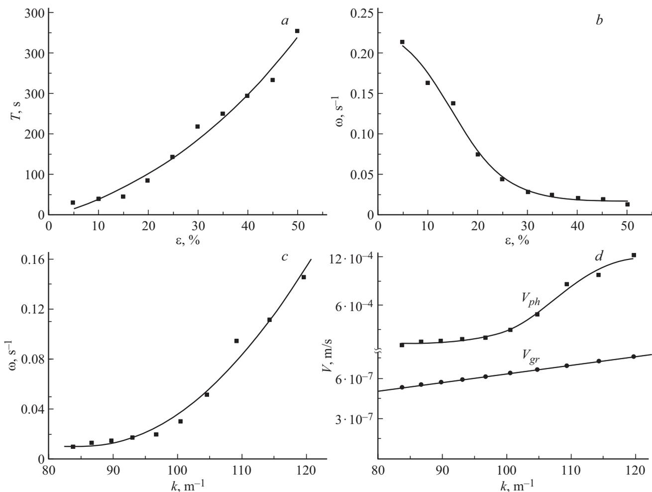
**Рис. 4.** Зависимость временного периода фронтов деформации (a) и частоты (b) от общей деформации. Закон дисперсии автоволн при скачкообразной деформации (c); зависимость фазовой и групповой скорости распространения автоволн от волнового числа (d).
