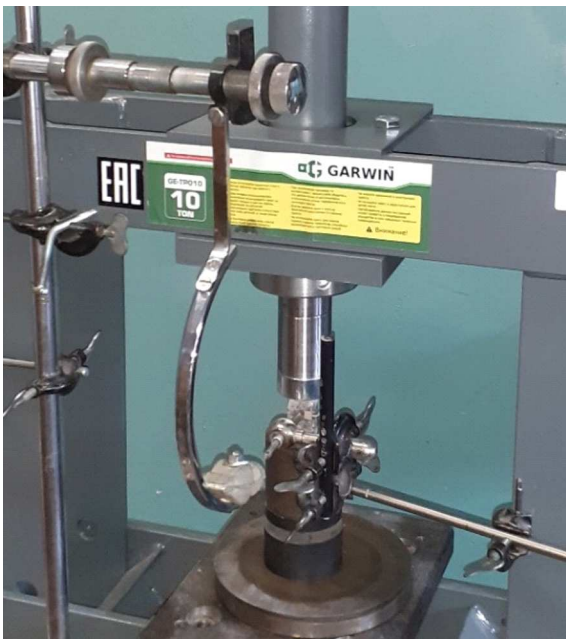
Рис. 1. Фотография установки для генерации АЭ при ударном повреждении одноосно сжатого образца ЦК.
