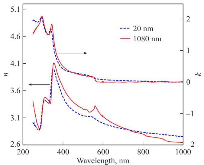
Рис. 1. Спектры оптических постоянных  $n(\lambda)$  и  $k(\lambda)$  пленок ZnTe, выращенных на подложке Si методом МЛЭ. Толщины пленок показаны на вставке рисунка.
