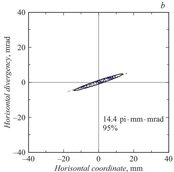
**Рис. 5.** Горизонтальная огибающая пучка ионов  $\text{Xe}^{+23}_{136}$  от входа в дефлектор до выходного фланца (a) и эмиттанс пучка в горизонтальной плоскости на выходном фланце циклотрона (b).
