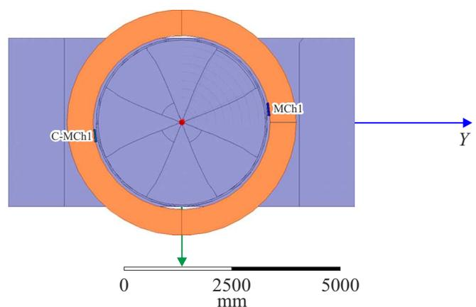
Рис. 1. Расчетная 3D-модель 1/2 части электромагнита с МК1 (MCh1) и компенсатором К-МК1 (С-MCh1), вид сверху.
