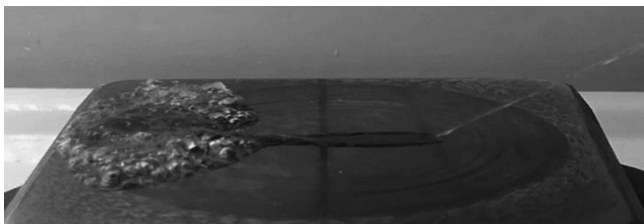
Рис. 2. Фотография процесса столкновения струи с поверхностью нагревателя при температуре T = 94^\circ\text{C} в центральной части на квазистационарной стадии процесса. Видимое на рисунке кипение жидкости объясняется тем, что температура пластины на периферии на 10–15°C выше, чем в центральной части.
