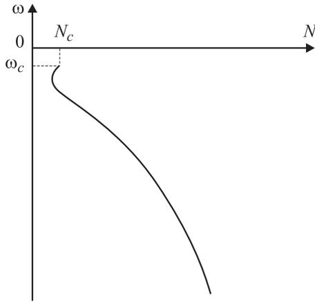
**Рис. 2.** Зависимость  $\omega(N)$  для локализованного между интерфейсами состояния в нелинейной фокусирующей среде.
