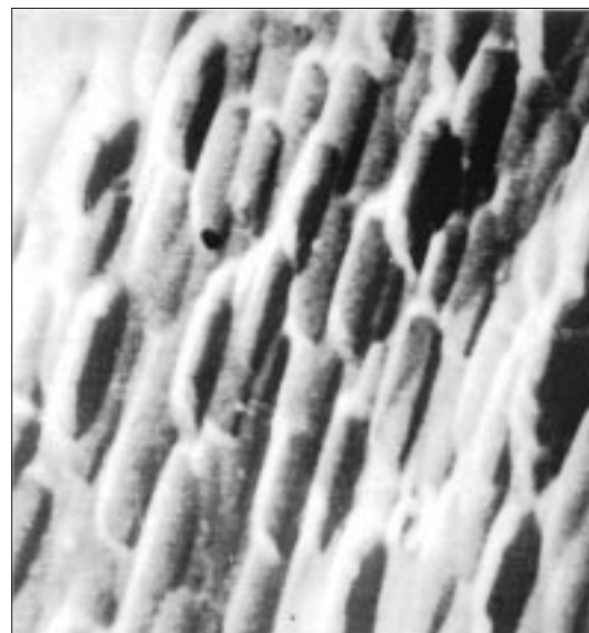
Рис. 4. Микроструктура поверхности свеженанесенной пленки сложных оксидов ( \times 10\,000 ).
