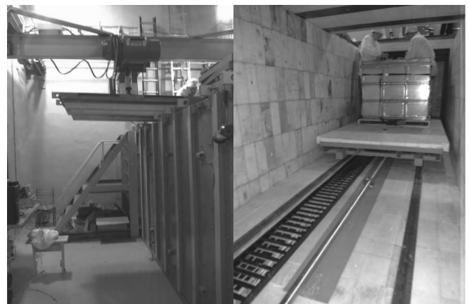
Рис. 3. Общий вид пассивной защиты снаружи и изнутри. Диапазон перемещений детектора в нейтринном канале составляет 6–12 м от активной зоны реактора.
