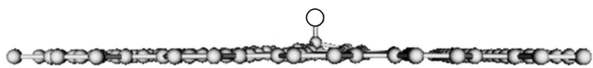
Рис. 2. Фрагмент графена с адсорбированным атомом водорода. Вид сбоку. Серые кружки — атомы углерода, белый кружок — атом водорода.
