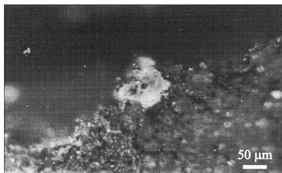
Рис. 2. Крупная частица на основе УДА на поверхности компакта после спекания в вакууме.
