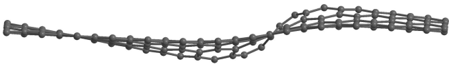
Рис. 6. Антисимметричный профиль поперечных смещений атомов сверхъячейки с двумя синусоподобными дефектами Стоуна–Уэльса в конфигурации A при минимально возможном расстоянии между корами (рис. 3, a ). Вид сбоку в направлении нормали к корам дефектов.
