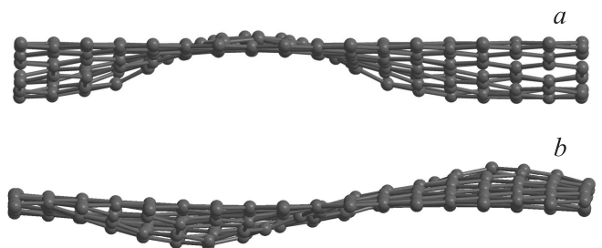
Рис. 10. Симметричный ( a ) и антисимметричный ( b ) профили поперечных смещений атомов сверхъячейки с двумя квазикосинусоподобными (см. текст) дефектами Стоуна–Уэльса в конфигурации C . Коры смещены в одну ( a ) или в разные ( b ) стороны от плоскости монослоя. Вид сбоку в направлении нормали к корам дефектов.
