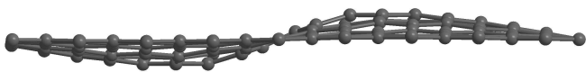
Рис. 8. Антисимметричный профиль поперечных смещений атомов сверхъячейки с двумя синусоподобными дефектами Стоуна–Уэльса в конфигурации B . Находящиеся друг напротив друга атомы разных коров смещены в одну сторону от плоскости монослоя. Вид сбоку в направлении нормали к корам дефектов.
