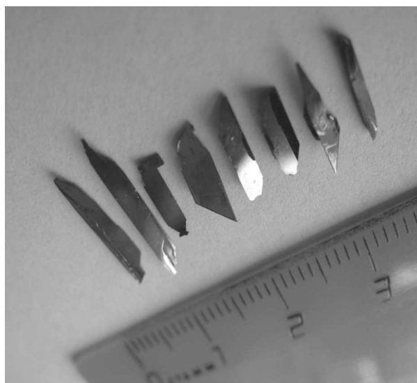
Рис. 1. Вид выращенных монокристаллов \text{Cu}_2\text{ZnSnS}_4 .
