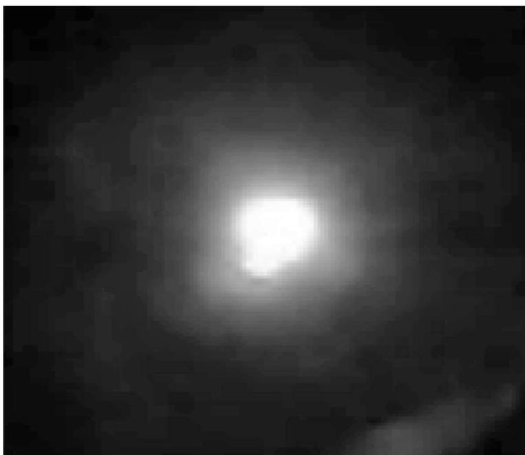
**Рис. 1.** Фотография свечения плазмы наносекундного разряда в воздухе атмосферного давления между электродами из поликристаллического халькопирита —  $\text{CuInSe}_2$  (размер свечения по вертикали примерно равен межэлектродному расстоянию — 2 mm).
