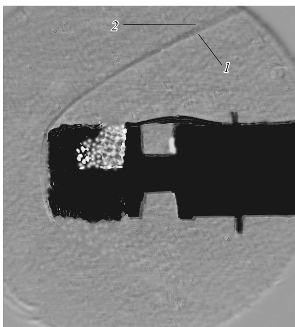
Рис. 3. Шлирен-визуализация положения головной ударной волны при отсутствии (1) и наличии (2) тлеющего разряда на одной из пористых вставок модели.
