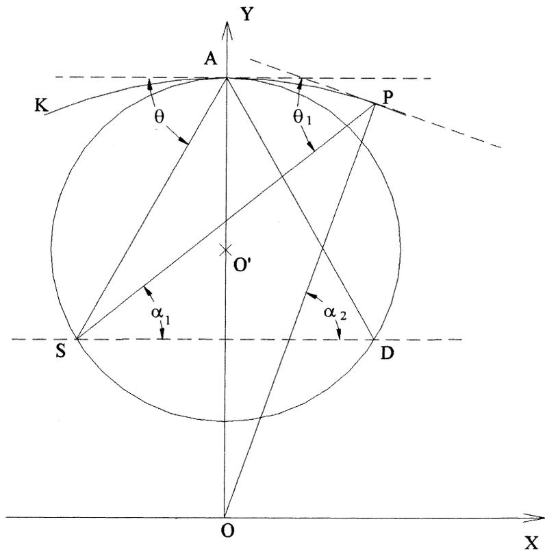
Схема расположения источника излучения  $S$  и изогнутого кристалла  $K$  в плоскости круга фокусировки.
