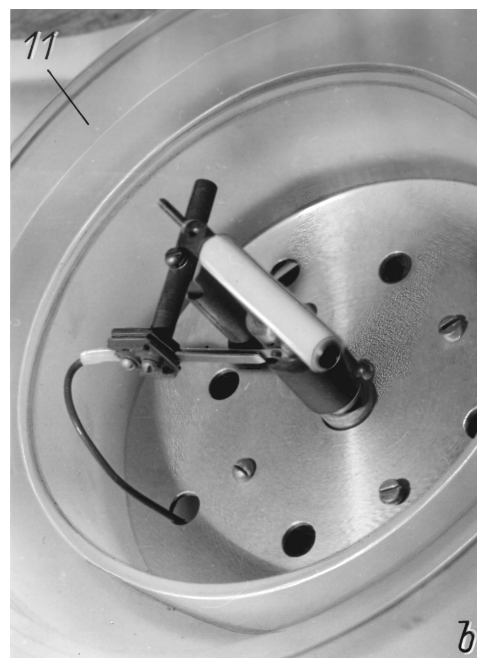
Рис. 2. Конструктивное исполнение устройства с одним цилиндром Фарадея (а), установленное устройство (б): 1 — цилиндр Фарадея, 2 — защитно-изоляционный кожух, 3 — держатель диэлектрический, 4 — переходная втулка-вал, 5 — токопроводящая втулка, 6 — прижимная клемма, 7 — электродвигатель, 8 — держатель прижимной клеммы, 9 — столик, 10 — провода, 11 — опорный изолятор.
