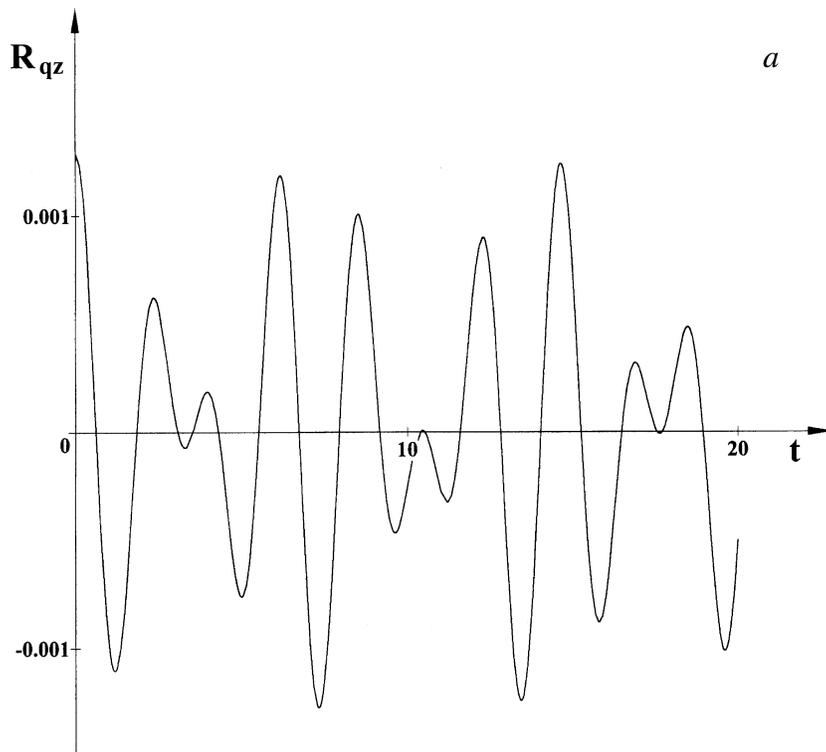
Зависимость безразмерного смещения центра заряда осциллирующей капли  $R_{qz}$ , связанная с возбуждением трансляционной моды ( $j = 1$ ), от безразмерного же времени  $t$ , когда начальная деформация равновесной сферической формы капли задана в виде:  $a = 0.5\varepsilon (P_3(\mu) + P_4(\mu))$ ;  $b = 0.5\varepsilon (P_{10}(\mu) + P_{11}(\mu))$ .
