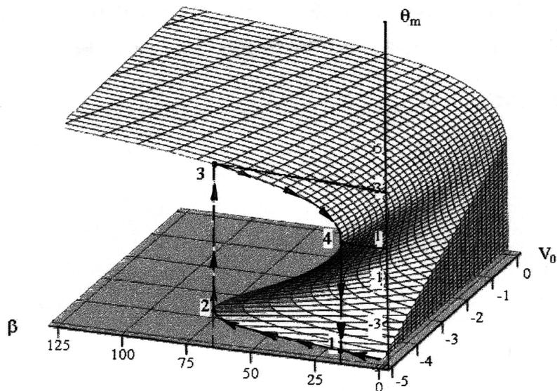
**Рис. 2.** Температура центра диэлектрика  $\vartheta_m$  в пространстве параметров  $(\beta, V_0)$ .  $V_0^* = -5$ .
