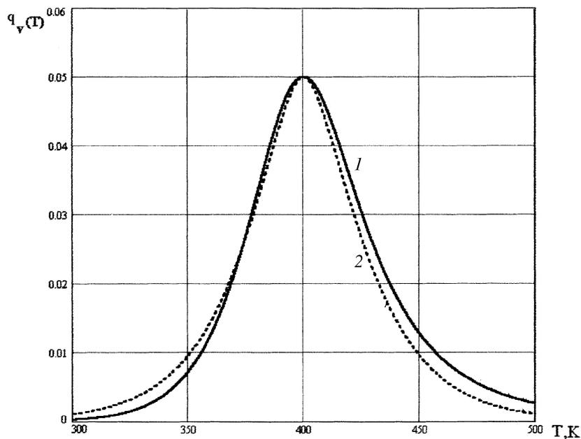
**Рис. 1.** Вид источников объемного тепловыделения в соответствии: 1 — с формулой Кирквуда (6) и 2 — модельного (7).
