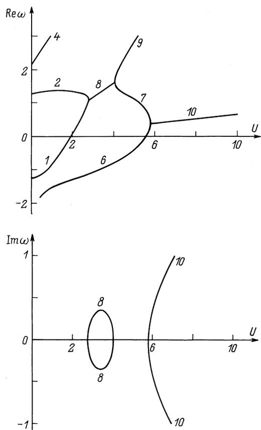
**Рис. 6.** Зависимости действительной и мнимой компонент безразмерной комплексной частоты от безразмерной скорости направленного движения верхней жидкости при  $k = 1$ ,  $\alpha = 0.5$ ,  $h = 0.9$ ,  $W = 0$ ,  $\rho = 0.1$ .
