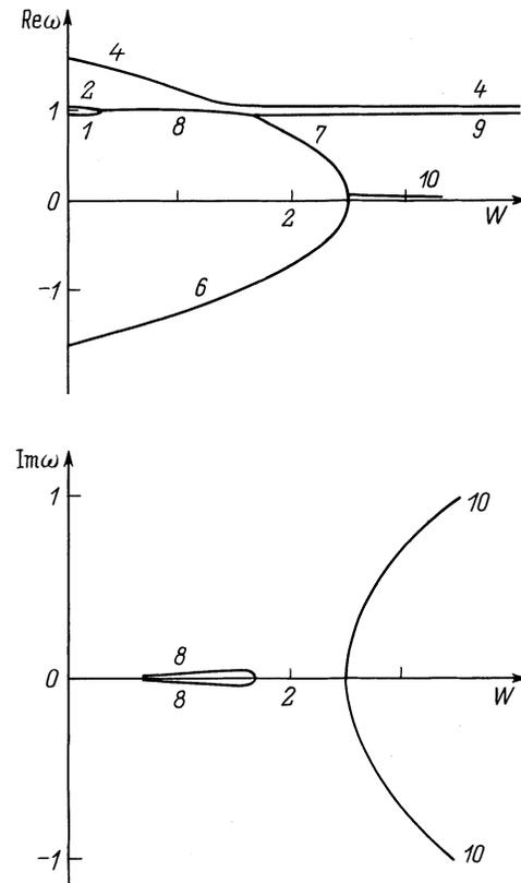
Рис. 5. Зависимости действительной и мнимой компонент безразмерной комплексной частоты от величины безразмерного параметра  $W$  при  $k = 1$ ,  $\rho = 0.5$ ,  $\alpha = 0.5$ ,  $h = 0.0001$ ,  $U = 1$ .
