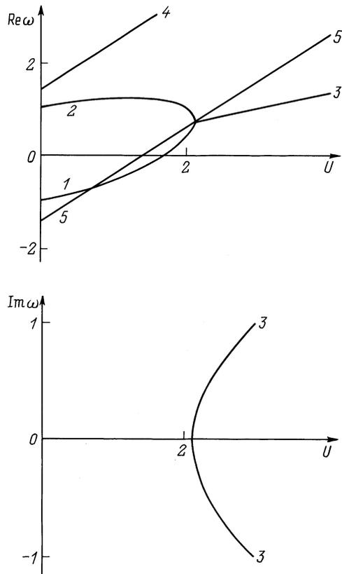
**Рис. 1.** Зависимости действительной и мнимой компонент безразмерной комплексной частоты от безразмерной скорости направленного движения верхней жидкости при  $k = 1$ ,  $\alpha = 0.5$ ,  $\rho = 0.5$ ,  $W = 0$ ,  $h = 5$ .
