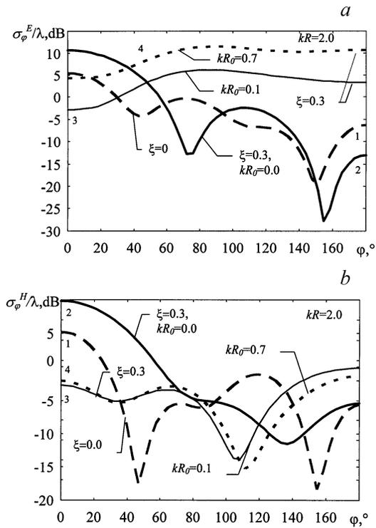
**Рис. 2.** Зависимости сечения поля рассеяния от угла падения волны: *a* — *E*-поляризованная падающая волна, *b* — *H*-поляризованная падающая волна. Обозначения: 1 — однородный диэлектрический цилиндр с потерями, 2 — однородный киральный цилиндр, 3, 4 — металлические цилиндры, покрытые киральными слоями.
