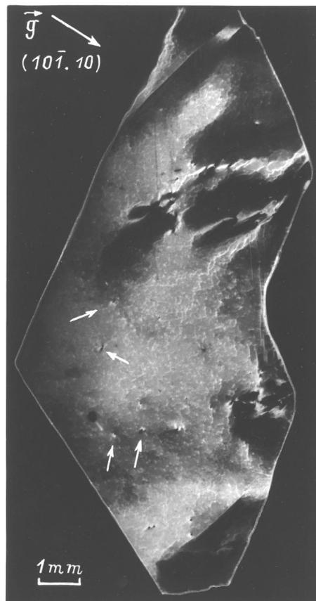
**Рис. 4.** Двухкристальная рентгеновская топограмма подложки с эпитаксиальным слоем ( $\text{CuK}\alpha$ -излучение,  $(10\bar{1}.10)$ -отражение). Видны дефекты с темным ядром и светлым ореолом — микропайпы.
