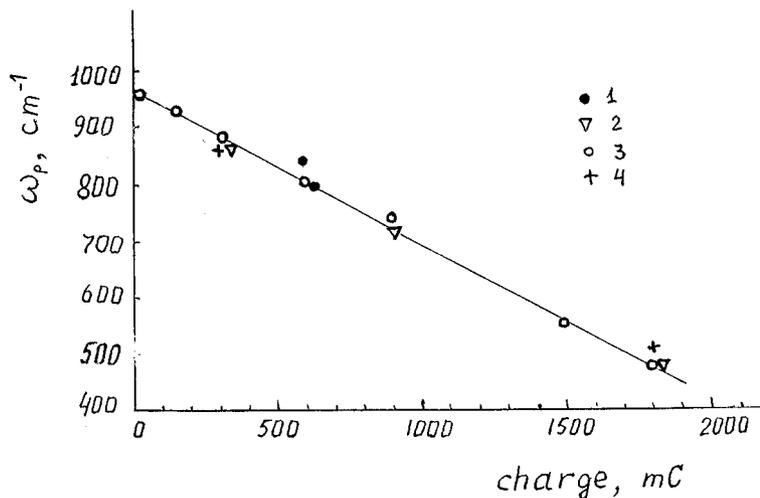
Зависимость частоты плазменного минимума от плотности заряда, протекавшего при анодировании кремния с концентрацией доноров  $2.3 \cdot 10^{19} \text{ cm}^{-3}$ . Плотность тока  $\text{mA/cm}^2$ : 1 — 2, 2 — 5, 3 — 15, 4 — 50.
