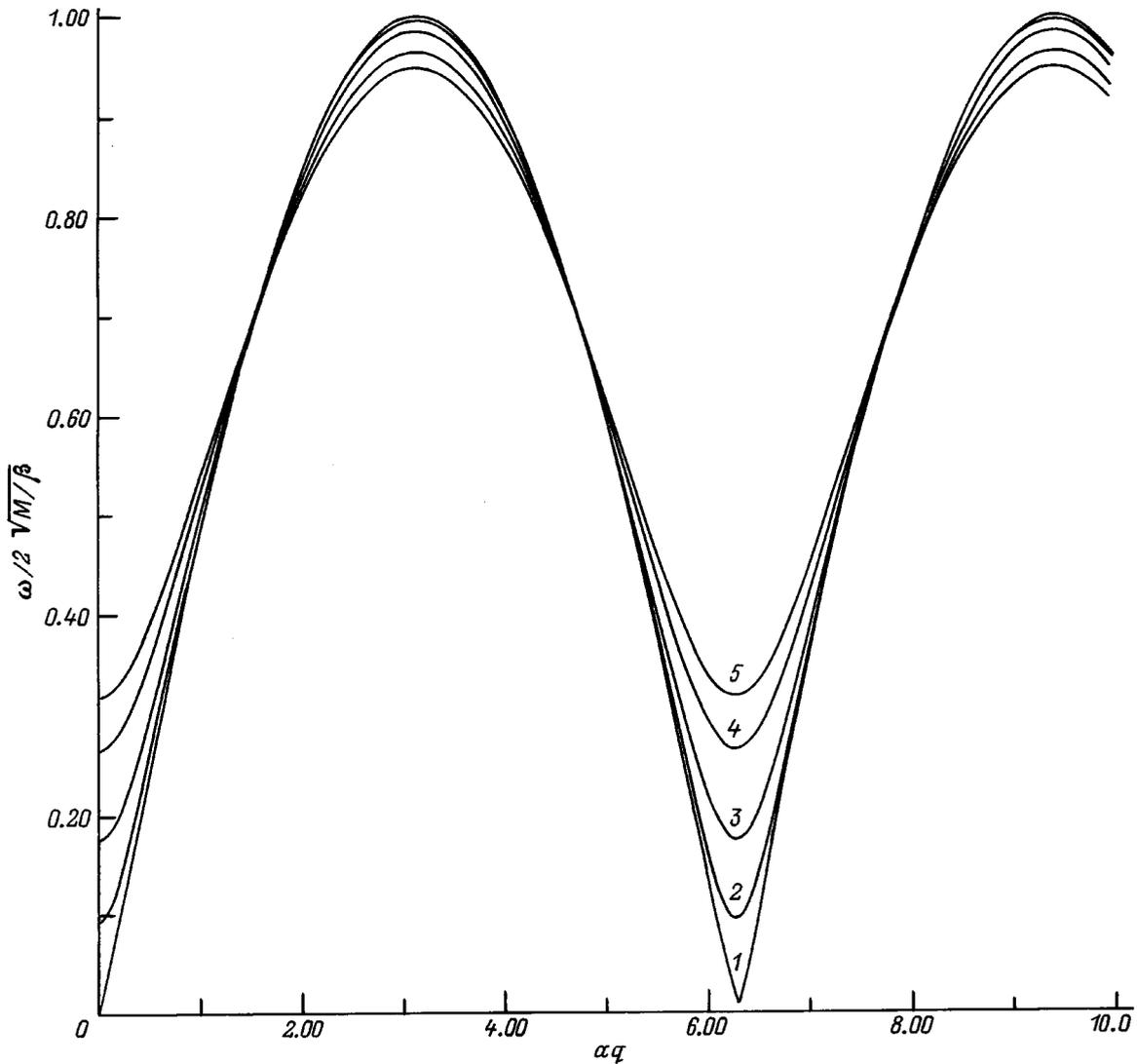
Рис. 3. Зависимость  $\frac{\omega}{2} \sqrt{\frac{M}{\beta}}$  от  $\alpha q$ :  $\alpha = 0$  (1), 10 (2), 20 (3), 30 (4), 40° (5).
