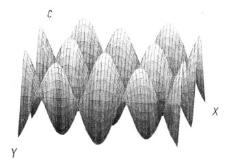
Распределение концентрации компонента C по пространственным координатам X,Y при спинодальном распаде фазы в условиях гиперболической диффузии.
