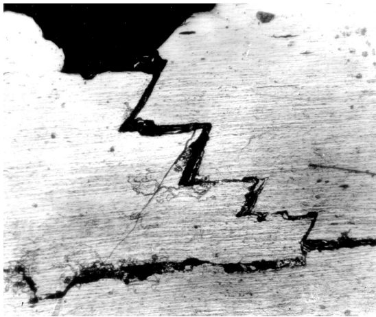
Строение трещины вблизи выступа в образце из стали Ц-85.
