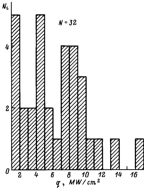
Рис. 1. Гистограмма плотностей мощности импульсного лазерного ИК излучения, соответствующих порогу оптического пробоя.
