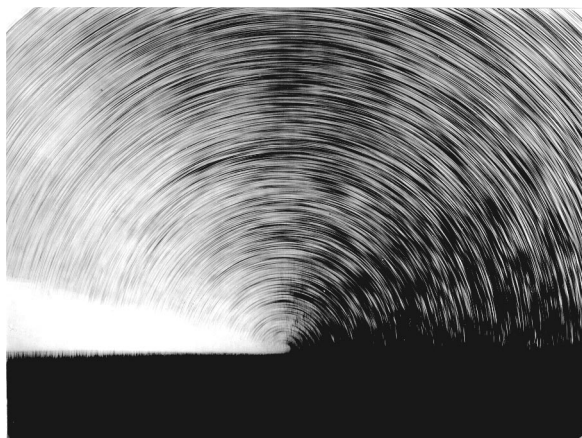
Рис. 2. Системы лазерных спеклов поверхностного и краевого происхождения в негативном изображении. Плоскость листа фотобумаги перпендикулярна прямому заостренному краю лезвия, расстояние от центра освещенного участка края до листа 5 см.
