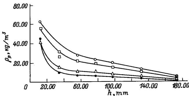
Рис. 3. Распределение плотности по высоте пенного столба в зависимости от времени выдержки пены.  $T$ , min:  $\circ$  — 2,  $\square$  — 3,  $\triangle$  — 4.5,  $\bullet$  — 6.
