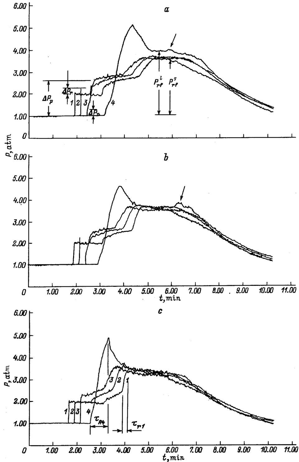
**Рис. 5.** Экспериментальные эпюры давлений при различных временах выдержки пены. 1–4 — номера датчиков;  $T$ , min:  $a$  — 2,  $b$  — 3,  $c$  — 6;  $M_i$ :  $a$  — 1.39,  $b$  — 1.33,  $c$  — 1.34.
