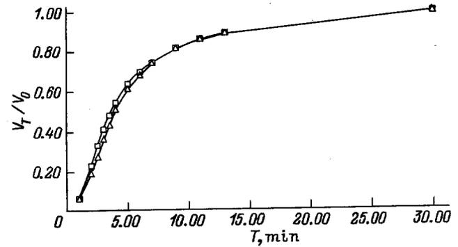
Рис. 4. Кривые вытекания жидкой фазы из пены.  $H$ , м:  $\square$  — 0.19,  $\triangle$  — 0.3.
