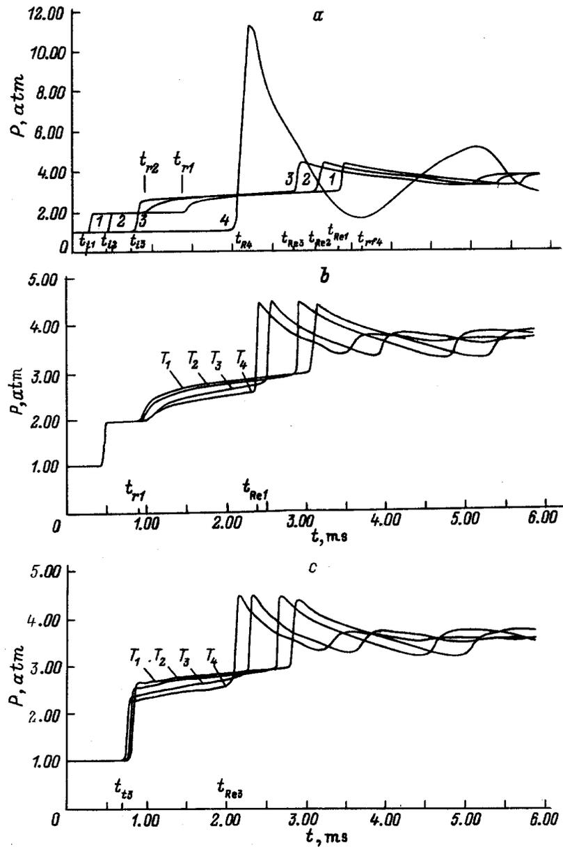
**Рис. 2.** Расчетные эпюры давлений. *a*: 1–4 — номера датчиков;  $t_i$ ,  $t_r$ ,  $t_t$ ,  $t_R$  и  $t_{Re}$  — времена прихода падающей, первичной отраженной, проходящей в пену, вторичной отраженной и прошедшей границу пена–воздух вторичной отраженной волн соответственно; *b* — давление на датчике 1 (время выдержки пены  $T_1 = 2$  min,  $T_2 = 3$  min,  $T_3 = 4.5$  min,  $T_4 = 6$  min); *c* — давление на датчике 3.
