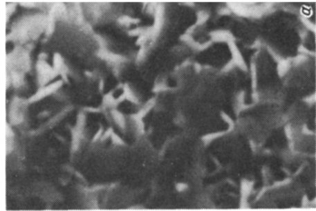
Рис. 2. Микроструктура пленок в зависимости от T_{\text{обр}} : а - 920 °C, б - 970 °C, в - 980 °C, г - 1010 °C.
