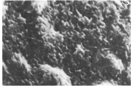
Рис. 2. Микроструктура пленок в зависимости от T_{\text{обр}} : а - 920 °C, б - 970 °C, в - 980 °C, г - 1010 °C.
