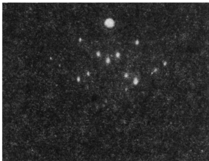
Рис. 1. Электронограмма пленки \beta -SiC на подложке Si ориентации (100). Толщина пленки 2.5 мкм.
