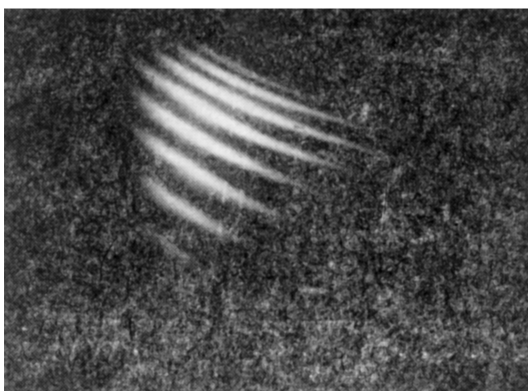
Рис. 3. Экспериментальные спектрально-угловые зависимости излучения генерации КТЛ с толщиной слоя l \approx 10 мкм.
