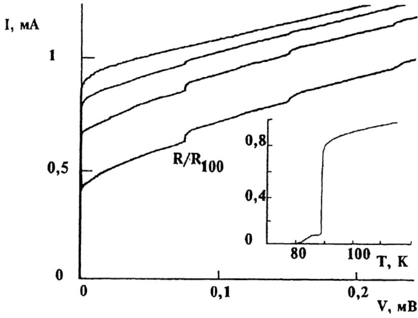
Автономная ВАХ YBCO мостика, пересекающего ступеньку из  $\text{CeO}_2$  (1), при  $T = 4.2$  К и семейство ВАХ (2-4) при воздействии микроволнового излучения частотой 37 ГГц и мощностью 5 мВт при различных затуханиях в тракте 40, 35, 26 дБ соответственно. На вставке приведена зависимость его сопротивления от температуры.
