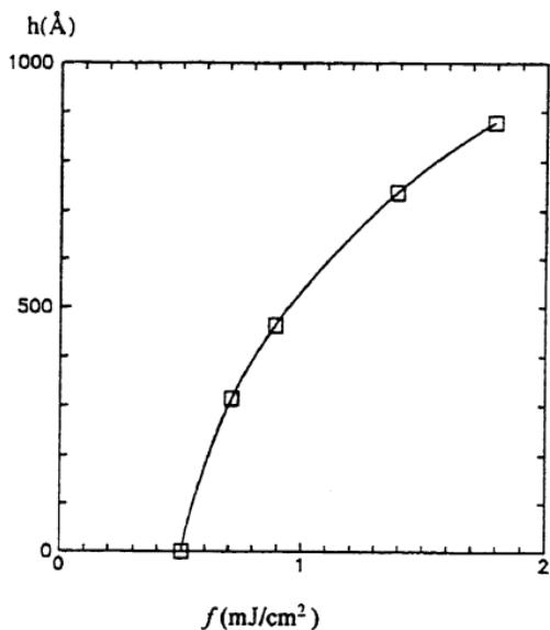
Зависимость толщины слоя, оставшегося после проявления  $h$ , от плотности энергии в импульсе  $f$  для фиксированной дозы  $D = 30 \text{ Дж/см}^2$ . Исходная толщина пленки  $4300\text{\AA}$ . В данном случае  $f \simeq 0.5 \text{ мДж/см}^2$ .
