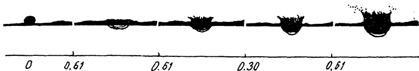
Рис. 1. Кинограмма процесса проникания капли H_2O в водную среду. Время между кадрами в миллисекундах указано на рисунке.
