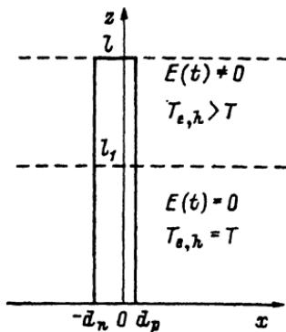
Расположение образца и токовых контактов в поле СВЧ волны.
