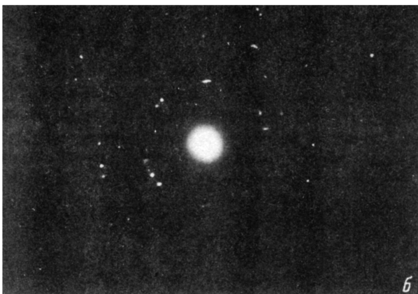
Рис. 3. Микродифракционные картины, полученные с двух пленок STO: с низкой (№ 148) (а) и высокой диэлектрической проницаемостью (№ 151) (б).
