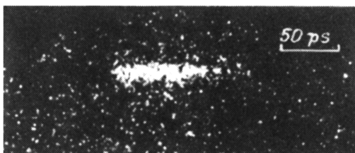
Рис. 2. Осциллограмма импульса генерации лазера с пассивным модулятором на основе пленки \text{VO}_2 .
