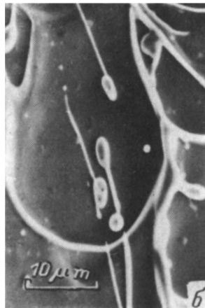
Рис. 3. Сфероидальная капля (а) и оторванные капли и «вены» (b) на поверхности сдвигового разрушения.
