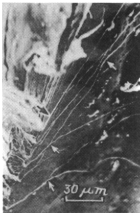
Рис. 1. Полосы сдвига (указаны стрелками) на цилиндрической поверхности образца вблизи поверхности сдвигового разрушения.
