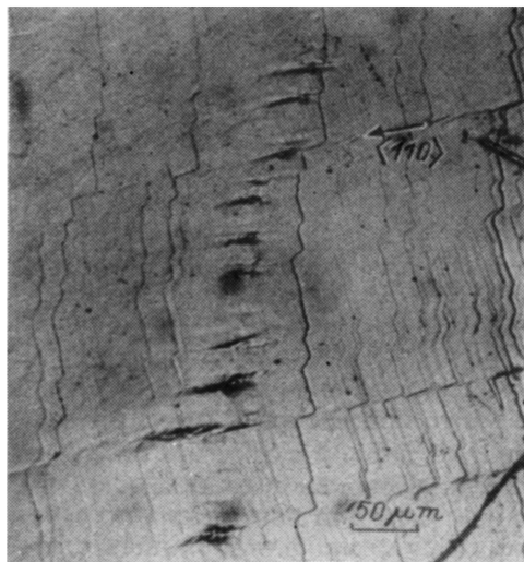
Рис. 2. Изменение рельефа краевой поверхности образца LiF на ряде локализованных сдвигов, положение которых четко видно по изгибам на ступеньках скола.
