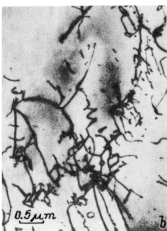
Рис. 3. Кластеры из междоузельных атомов ( D -тип микродефектов) в монокристаллах кремния (а) и их дислокационная активность (б).
