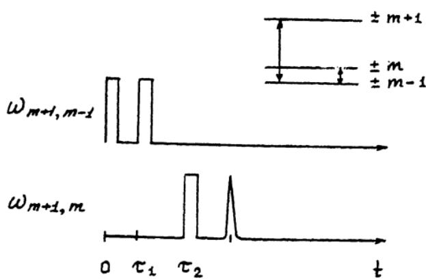
Импульсная программа двухчастотного воздействия на трехуровневую систему.
