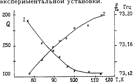
Рис. 2. Зависимости добротности (1) и резонансной частоты (2) ОР от температуры.
