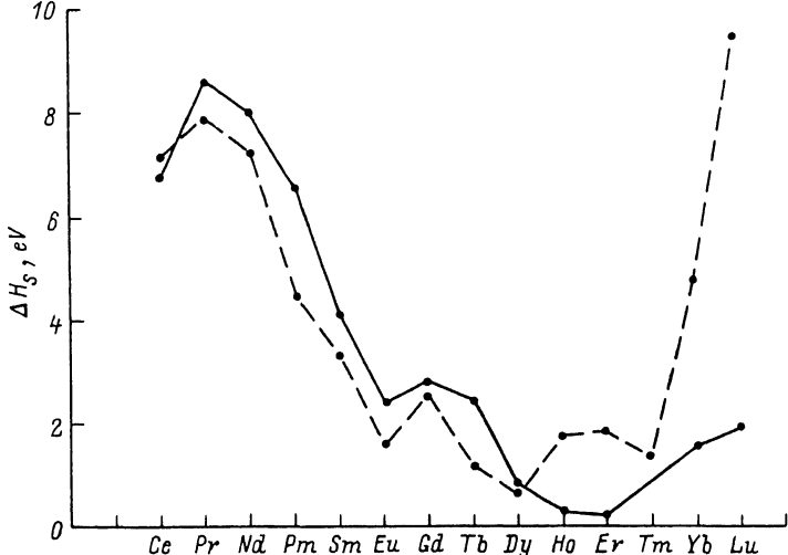
Рис. 5. Энтальпии растворения f -примесей в кремнии в нейтральном (штриховая линия) и ионизованном (сплошная) состояниях.
