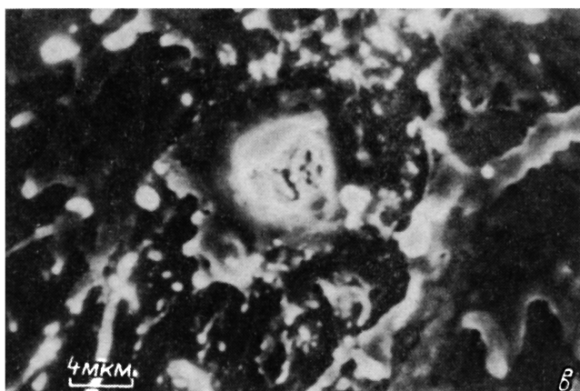
Рис. 2. Типичные повреждения, вызванные воздействием СЭП в кристалле KCl (а) (б — образование из них микротрещин) и в низкоомном германии (в).
