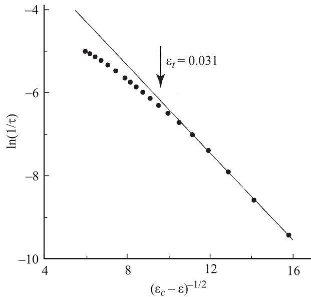
**Рис. 1.** Зависимость величины  $\ln(1/\tau)$  от параметра  $(\varepsilon_c - \varepsilon)^{-1/2}$  для двух однонаправленно связанных систем Ресслера (2). Точки, полученные численным интегрированием системы (2), изображены символом  $\bullet$ . Теоретическая зависимость (1) для перемежаемости типа „игольного ушка“ показана сплошной линией. Стрелкой отмечена граница возникновения режима перемежаемости „игольного ушка“.
