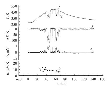
Динамика изменения температур торцевых областей образца (1,2), разницы их температур (3), возникающей при этом ЭДС (4) и значений термоэдс (5) в процессе нагревания и охлаждения монокристалла SmS.
